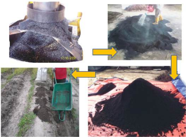
Gambar rajah 1: Proses pembuatan baja organik BioRICHAR
