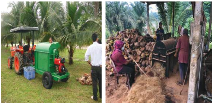
Gambar 1: Mesin pengekstrak cocopeat dan fiber sabut kelapa
