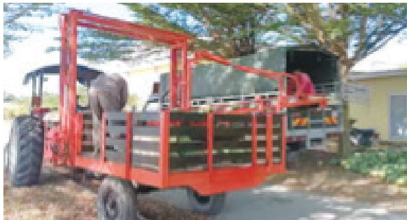
Gambar 13: Treler bantuan penuaian digunakan untuk memuat naik buah tembikai ke dalam lori pemborong
